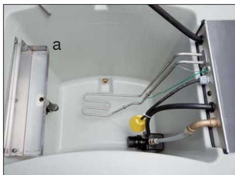
Abb.1: Innenansicht des Tanks mit Überlaufbecken (a) für aufschwimmende Fette und Öle (links)
